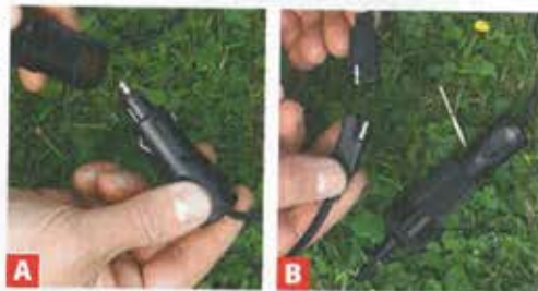
Ein Adapter für Kfz-Geräte wird über einen verpolungssicheren Stecker angeschlossen.
