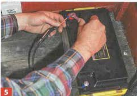
5 Installieren Sie alle Komponenten des Systems. Zum Schluss die Batterie polrichtig anklammern und das Modul anschließen.
